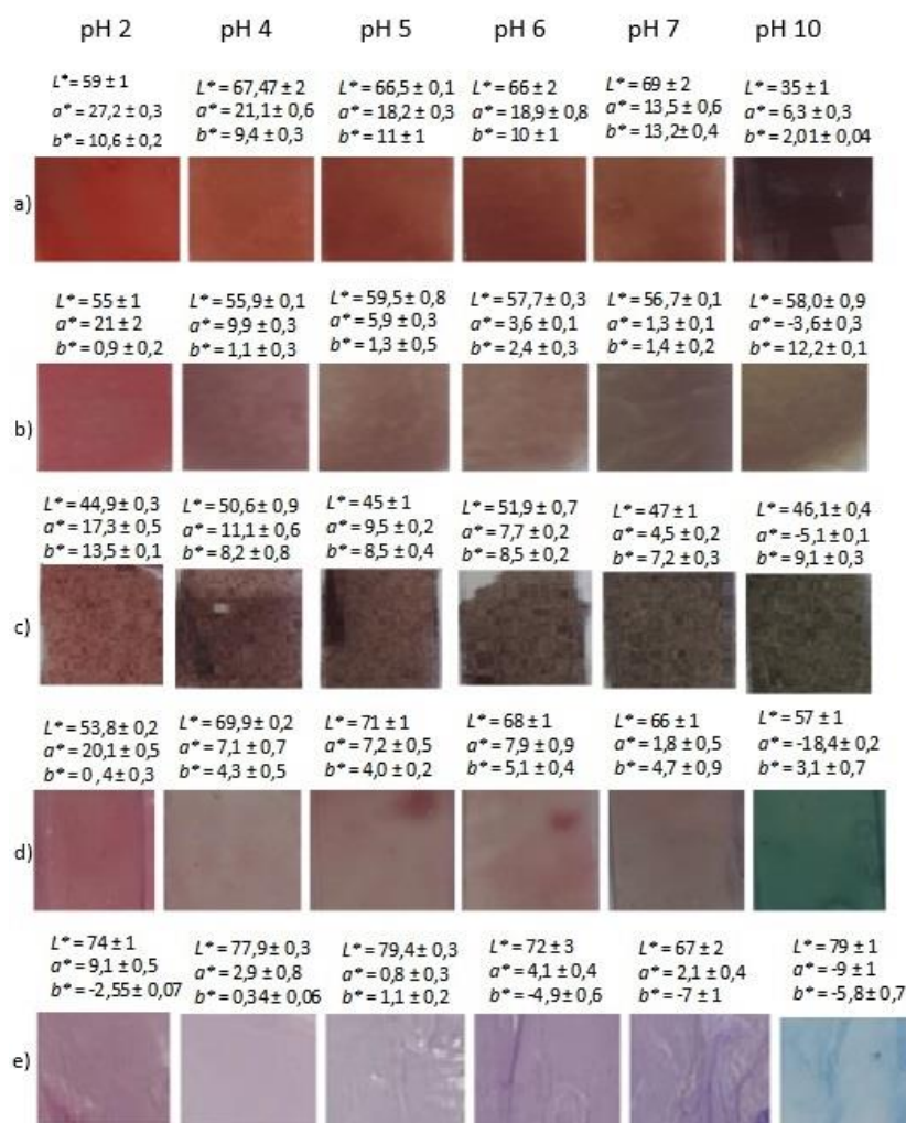
Figura 1 – Indicadores após imersão em soluções tampão de diferentes valores de pH: a) filme de amido e rabanete; b) filme de amido e repolho roxo; c) filme de amido e pó do bagaço de uva; d),filme de amido e extrato do bagaço de uva; e) filme de celulose bacteriana e extrato do bagaço de uva.
