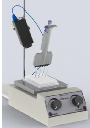
Figura 1 – Instrumentação utilizada para determinação de sódio, através da Entalpiimetria no Infravermelho (TIE).
