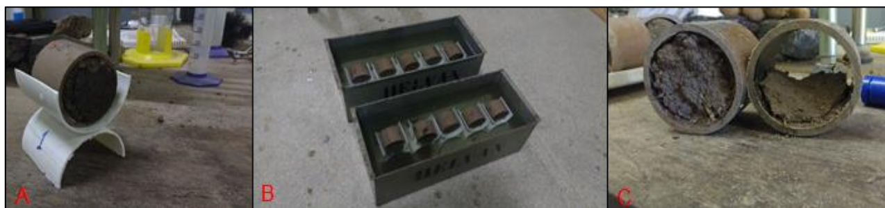
Figura 7. (A) Amostra acoplada ao suporte; (B) Conjunto de amostras/suportes dentro de um recipiente imersos com água; (C) Amostra indeformada desprendida seca. Figura do autor.
