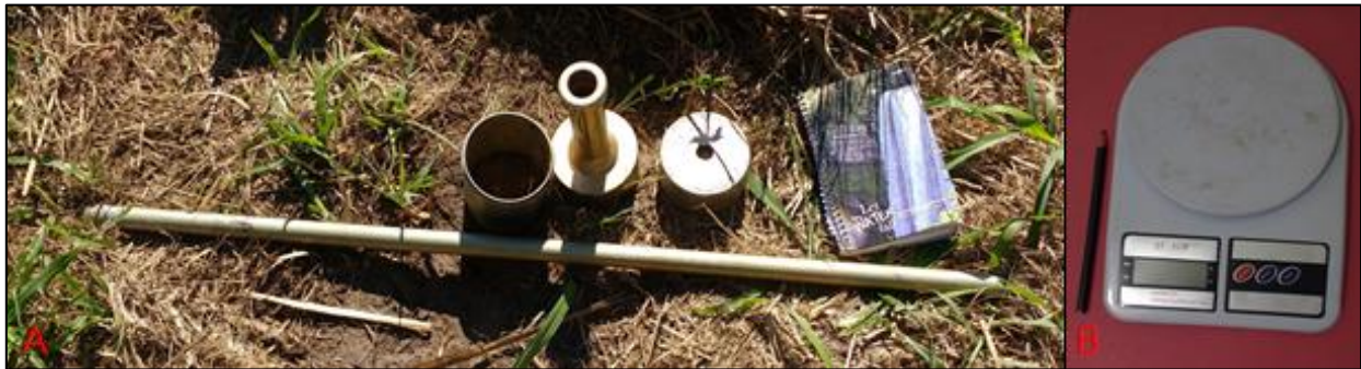
Figura 7. (A) Haste guia, cilindro de cravação, soquete de cravação e colarinho destacável (da esquerda para direita); caderneta de campo como escala; (B) Balança com precisão de 1 grama.
