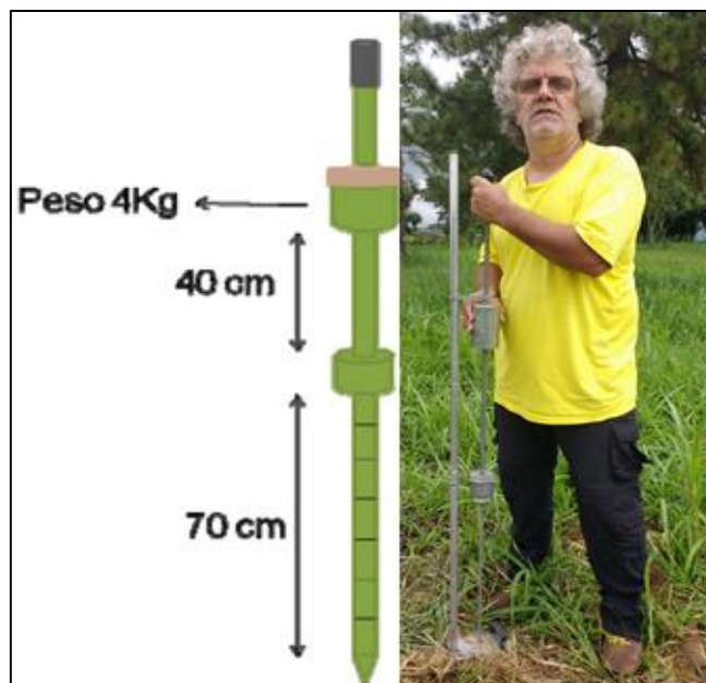
Figura 6. Penetrômetro de impacto (Modelo IAA\Planalsucar – Stolf) sendo operado em campo. Retirado de GUIMARÃES, 2008.
