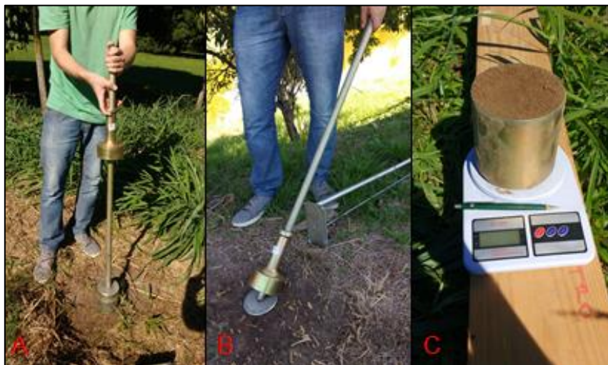
Figura 8. Procedimento do ensaio: (A) Assentamento do cilindro de cravação na superfície do terreno; (B) Cravação do cilindro no solo; (C) Pesagem da amostra indeformada. Figura do Autor.
