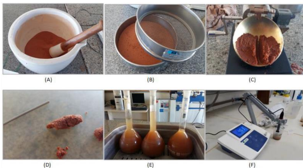
Figura 2. Ensaios de Caracterização das areias eólicas da Região da Campanha Gaúcha : (A) Preparação de amostras; (B) Ensaio de Granulometria; (C) Limite de Liquidez; (D) Limite de Plasticidade; (E) Massa Específica dos Grãos; (F) Ensaio pH.
