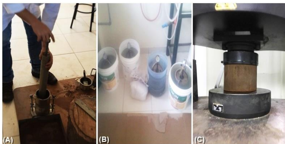
Figura 3. (A) Ensaio de compactação das misturas solo-cimento; (B) Ensaio de Expansibilidade; (C) Ensaio de resistência à compressão simples.
