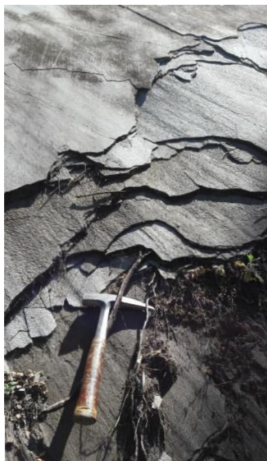
Figura 7 – À direita tem-se a visão geral do talude Mangabeiras exibindo cicatriz de ruptura planar segundo F1. À esquerda exibe-se detalhes da ruptura ao longo de F1.
