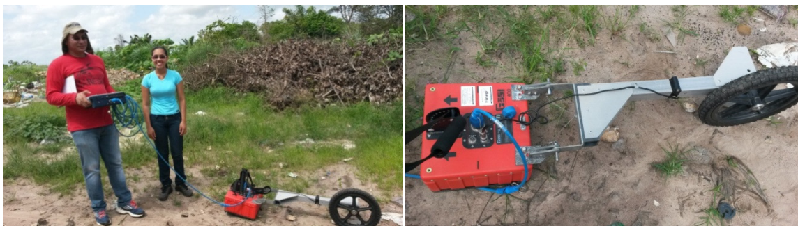
Figura 3. Equipamento GPR da empresa GSSI SIR3000 utilizado nas coletas dos dados geofísicos.
