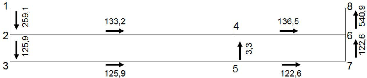
Figura 6. Vazões nos ramos calculadas pelo programa VentoNL, método de Newton-Raphson.
