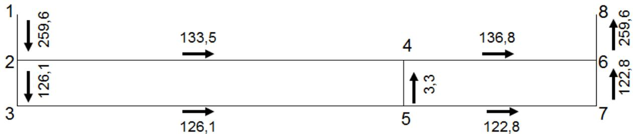
Figura 7. Vazões nos ramos calculadas pelo programa Vento2007, método de Cross (1936).
