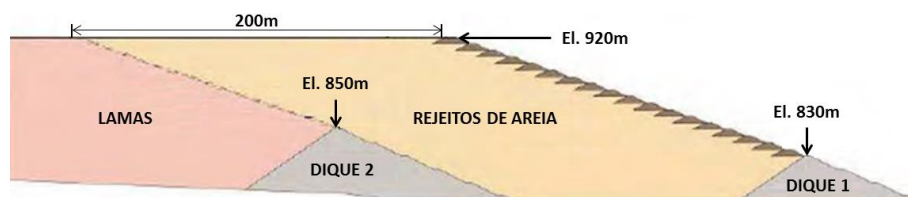
Figura 2. Método de alteamento à montante adotado para Fundão (Fonte: MORGENSTERN et al., 2016).
