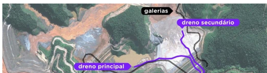
Figura 3. Sistema inicial de drenagem na barragem de Fundão (Fonte: BERTONI et al., 2016).
