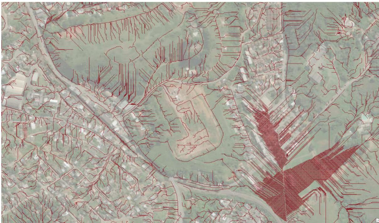
Figura 9 – Sobreposição dos Fluxos e Caminhos que as águas pluviais percorrem, considerando a topografia local em um trecho da zona urbana.
