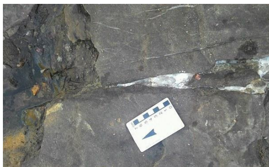
Figura 2 – Arenito fino bem litificado com fraturas preenchidas por calcita.
