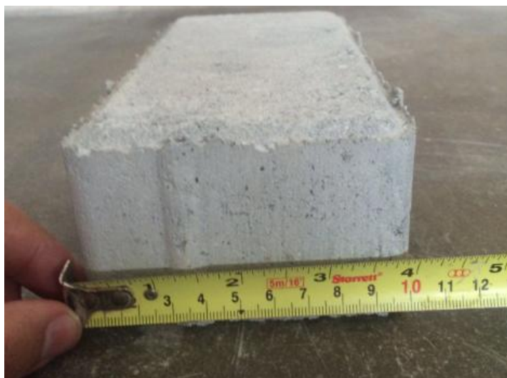
Figura 3- Medição das peças de concreto para pavimentação.
