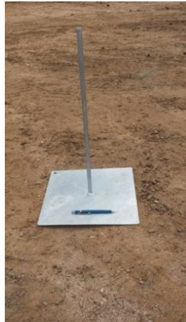
Figura 3 - Placa metálica para o monitoramento dos recalques
