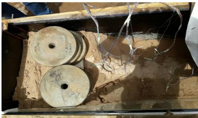
Figura 9: Vista superior do talude rompido com a sobrecarga de anilhas
