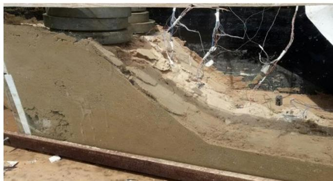
Figura 8: Vista frontal do talude rompido com a sobrecarga de anilhas
