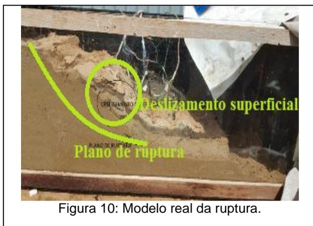
Figura 10: Modelo real da ruptura.
