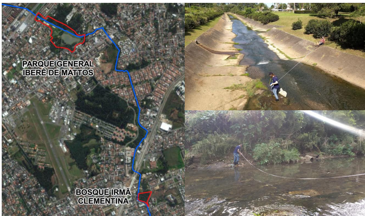
Figura 1. Imagem de satélite com destaque para o Rio Bacacheri e para áreas de estudo e foto das seções em que foram realizadas as batimetrias.
