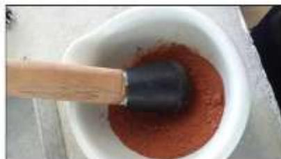
Figura 5. Destorroamento do solo em laboratório.
