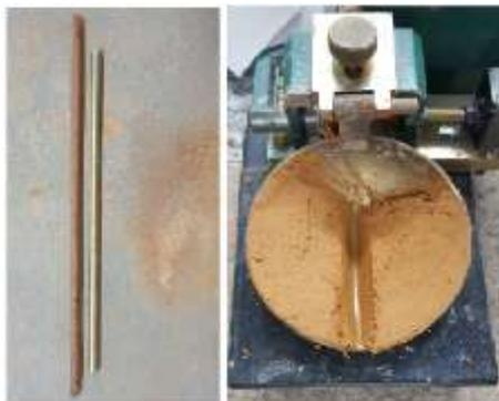
Figura 7a. Comparação da amostra e o gabarito para determinação do limite de plasticidade (NBR 7180/1984) e Figura 7b. Amostra no aparelho de Casagrande para determinação do limite de liquidez.
