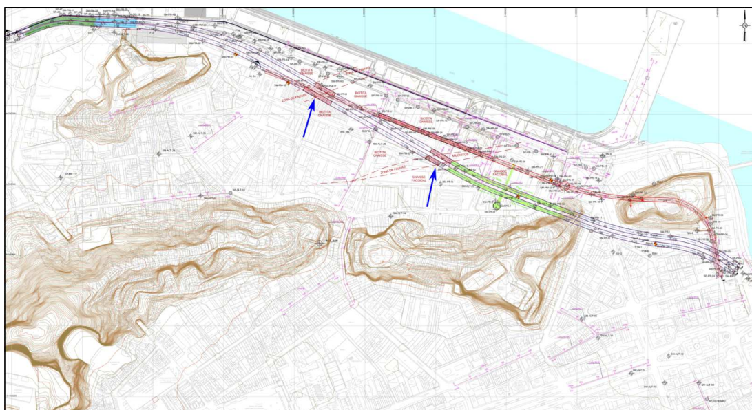
Figura 4. Localização das zonas de falha atravessadas pela escavação, destacadas pelas setas.
