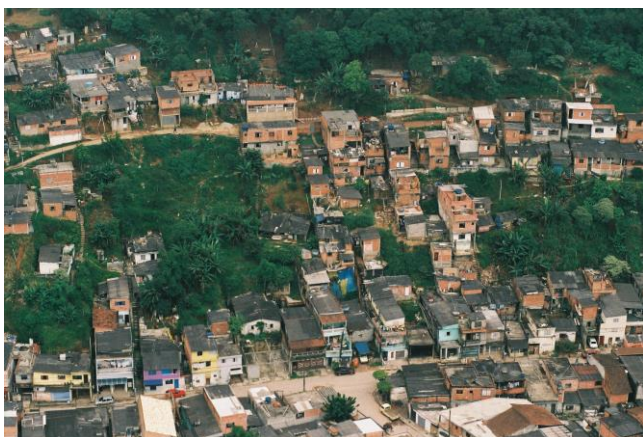
Figura 3: Encosta no bairro Areião, ocupação na base e no topo de encosta natural com diversas intervenções de corte e aterro. A parte central da foto mostra ainda ocupação a meia encosta. (São Bernardo do Campo, 2010b).
