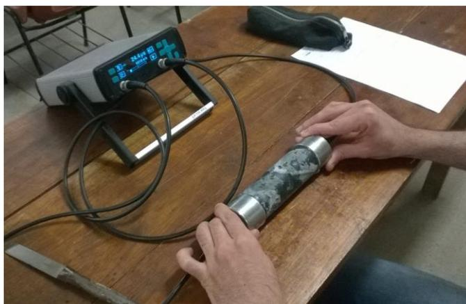
Figura 4. Esquema de ensaio de velocidade de propagação de ondas.
