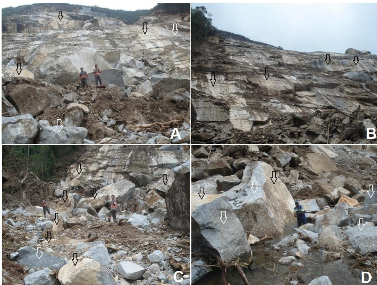
Figura 9: Vista frontal da cicatriz do escorregamento. As setas pretas indicam as faces que apresentam capa de intemperismo; as setas de cor branca apontam as faces ainda sãs ou com capa de intemperismo pouco desenvolvida (prováveis pontes de rocha). Fonte: Cosme/SABESP (22/11/2011).
