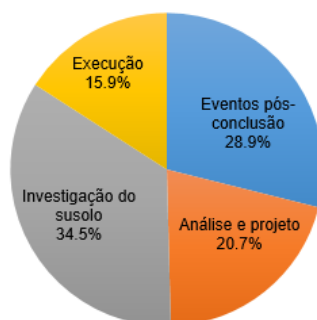
Figura 1.1 - Origem das patologias em fundações correntes no Estado do Rio Grande Sul
