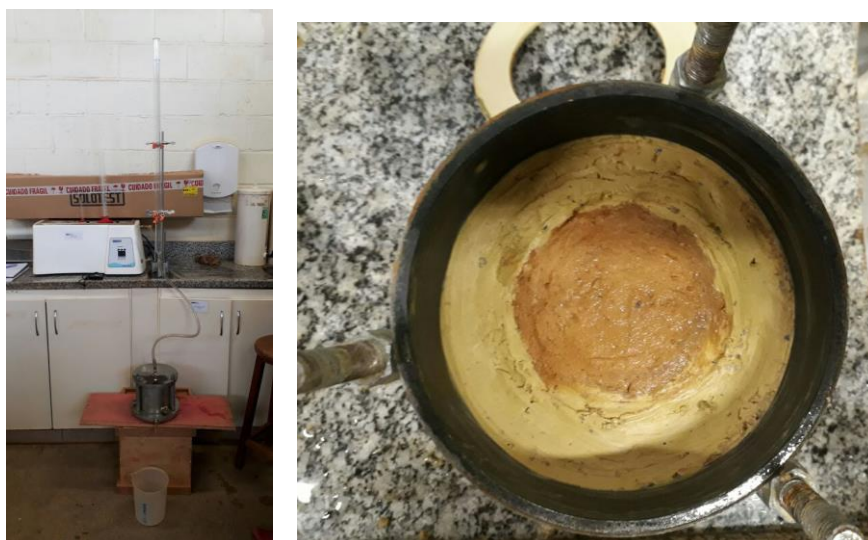
Figura 4. Ensaio de determinação do coeficiente de permeabilidade.
