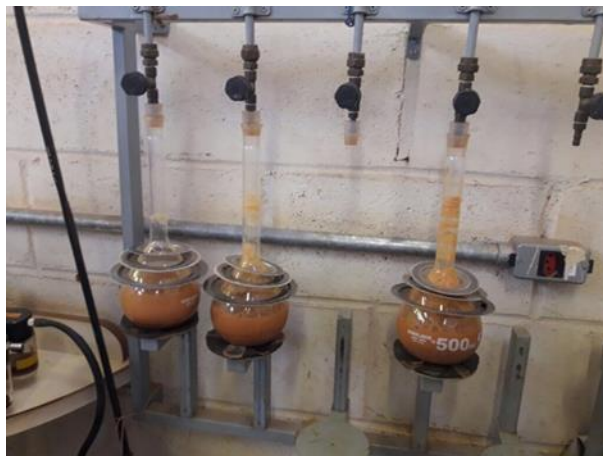
Figura 2. Ensaio de massa específica dos grãos.
