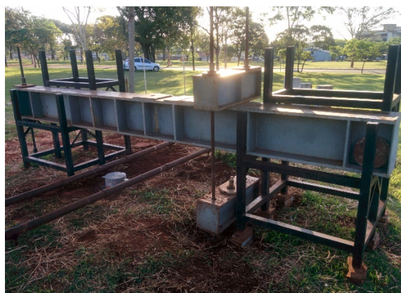
Figura 2. Esquema geral do sistema utilizado nas provas de carga Fonte: Adaptado de Almada (2016).
