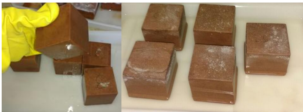
Figura 4 – Corpos de prova não alterados ao final do ensaio de imersão em ácido sulfúrico à esquerda e hipoclorito de sódio à direita
