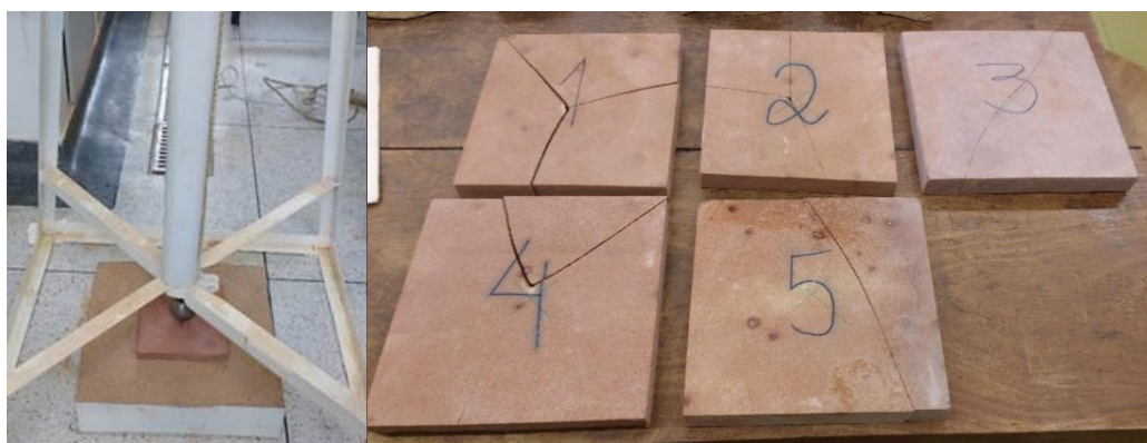
Figura 2 – Ensaio de resistência ao impacto de corpo duro (Laboratório de Geotecnia da UFSCar)
