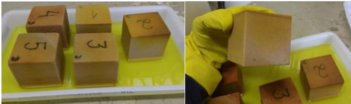
Figura 6 – Amostras e solução de ácido muriático com cores alteradas após ciclagem
