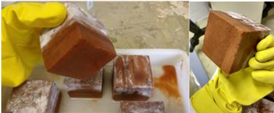
Figura 5 – Perda de grãos das amostras devido ao ensaio de alteração química com solução de hidróxido de sódio e corpo de prova com as arestas arredondadas devido à imersão na solução.
