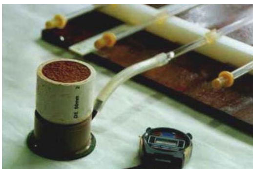
Figura 4. Execução do ensaio de infiltrabilidade (BASTOS, 1999).
